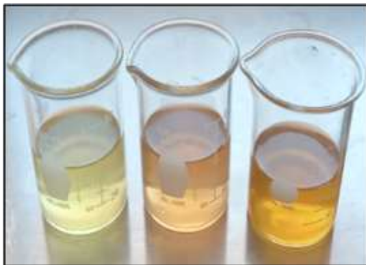
Figura 22. Medición de pH en diferentes muestras de jabón.
