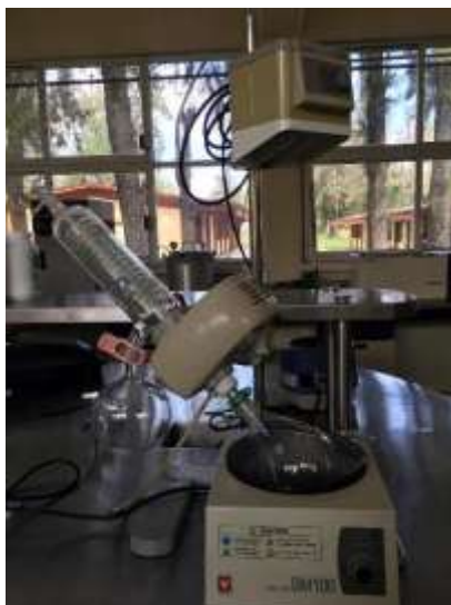
Figura 7. Eliminación del solvente con rota evaporador
